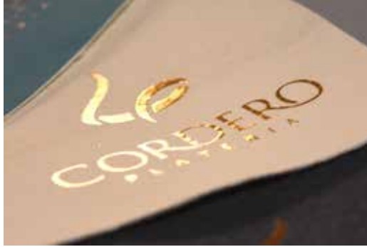
Imagen 35. Detalle de estampado. Pruebas de estampado foil sobre distintos cortes de micro cuero. Autor: Katherine Cordero
