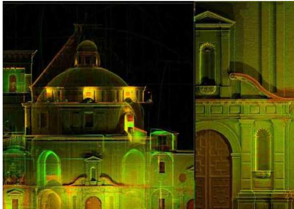
**Fig. 26.** Levantamiento mediante escaner laser de iglesia del Santo Cristo de la Salud
