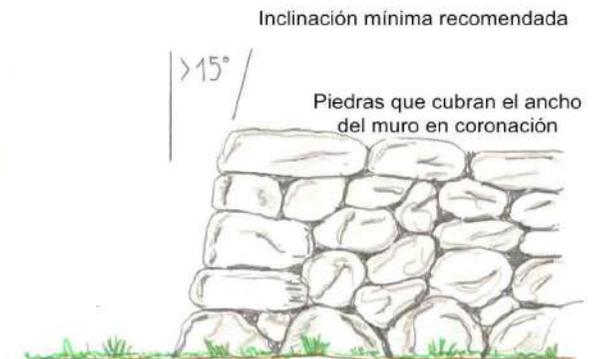
**Sección Muro Contención Tipo**
