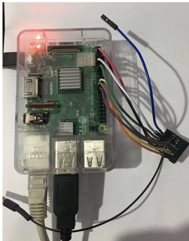
Figura C.5: Gateway LoRa en funcionamiento.
