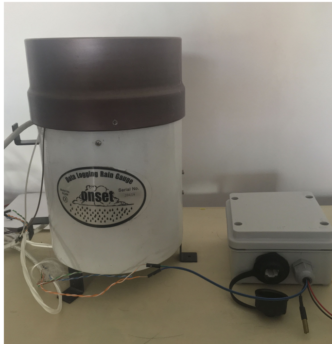
Figura C.6: Conexión del nodo y el sensor pluviométrico.
