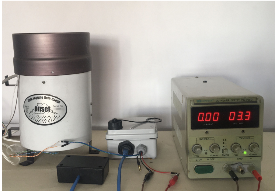
Figura C.8: Conexión del gateway WiFi al nodo para la descarga de datos in-situ .
