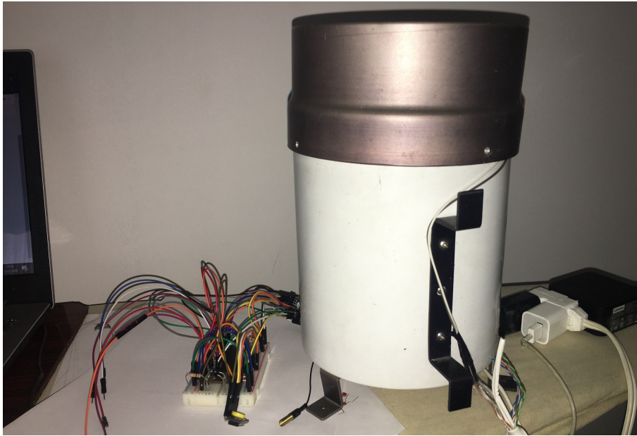
Figura C.2: Montaje del circuito en protoboard con sensor pluviométrico.
