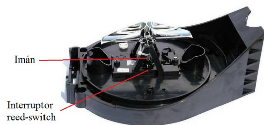
(b) Balancín del pluviómetro[33].
