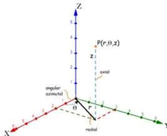
Figura 67: sistema tridimensional en coordenadas cilíndricas
