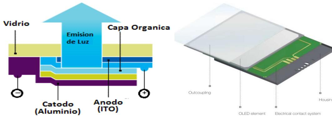
Figura 2-8 Estructura básica de un OLE
