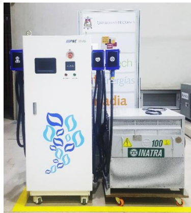
Figura 2.15. Estación de Carga Rápida del Laboratorio de Microrred de la Universidad de Cuenca. Fuente: Propia del autor.
