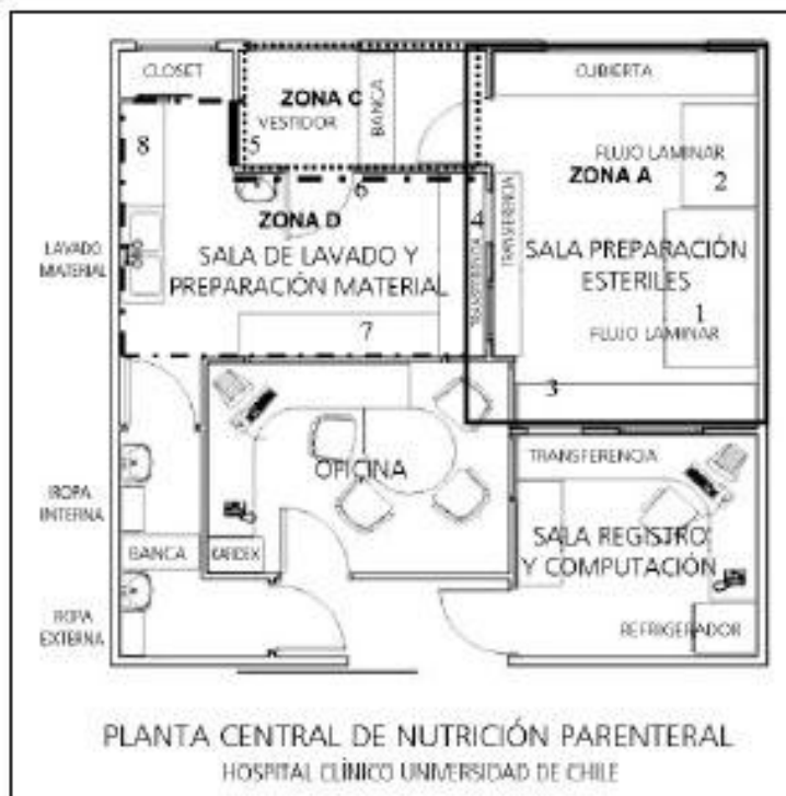
Figura 2. Unidad de preparación de nutrición parenteral (Caorsi , Sakurada, Ulloa, Pezzani, & Latorre, 2011).
