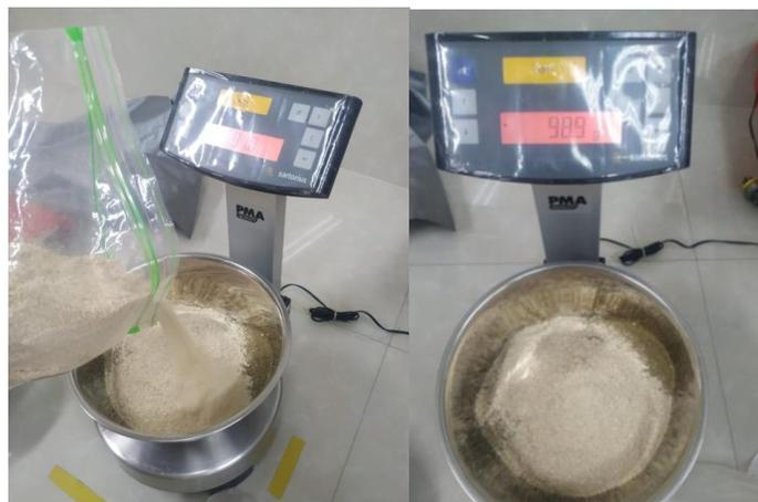
ILUSTRACIÓN 14: PESADO DE COMPONENTES SEGÚN LA DOSIFICACIÓN PLANTEADA
