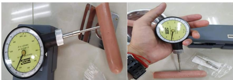
ILUSTRACIÓN 26: DETERMINACIÓN DE LA DUREZA EN SALCHICHAS TIPO VIENA
