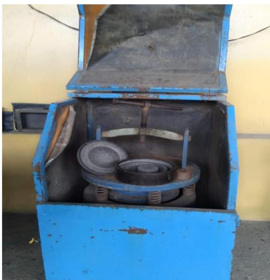
*Ilustración 9: Pulverizadora y discos*
