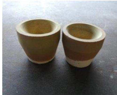
*Ilustración 6: Copelas usadas*
