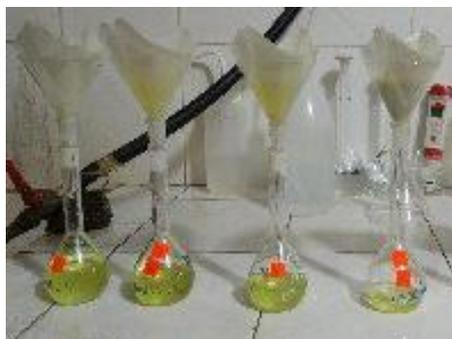
*Ilustración 19: Filtrado de la solución de citrato de plomo*
