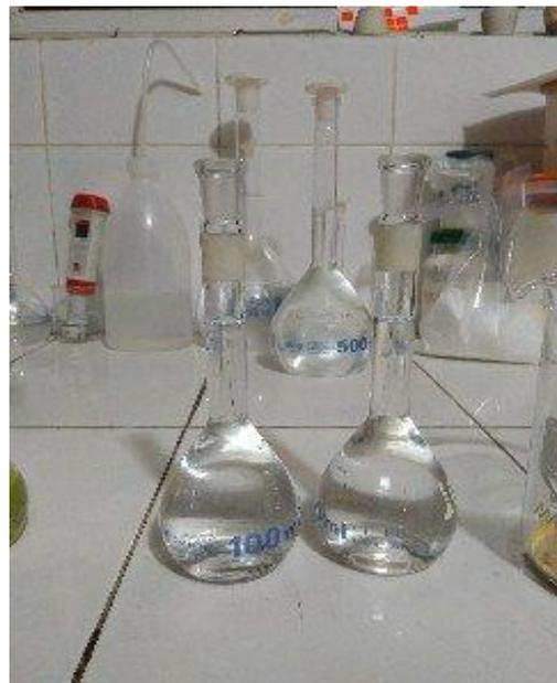
*Ilustración 31: Soluciones de ácido acético al 10%*
