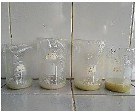
*Ilustración 17: Reacción de la solución lixiviante con ácido acético al 10%*
