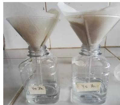
*Ilustración 20: Filtrado de la solución de acetato de plomo*
