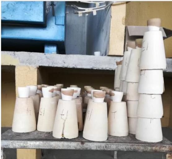
*Ilustración 28: copelas usadas*
