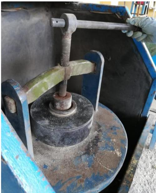
*Ilustración 30: Pulverizadora de discos*
