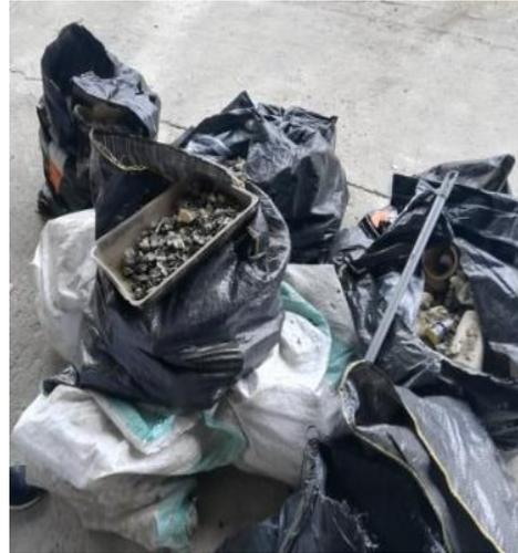
*Ilustración 33: Desechos de régulos, crisoles y copelas usadas*
