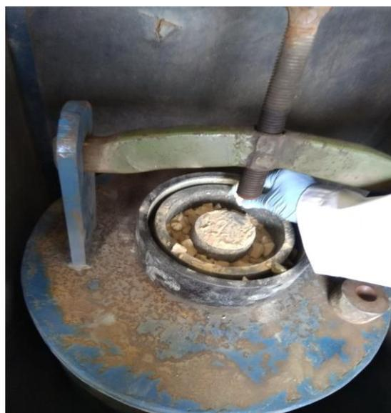
*Ilustración 10: Copelas trituradas listas para pulverizar*
