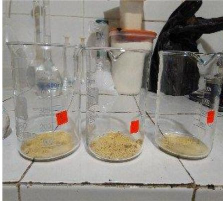
*Ilustración 15: Muestra de copela usada y pesadas según la relación S-L*
