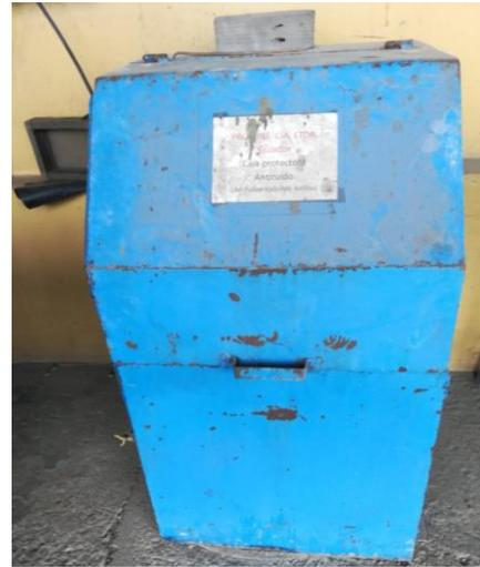
*Ilustración 29: Pulverizador de anillos, tapa cerrada*
