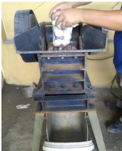
Ilustración 7: Trituración de copleas usadas
