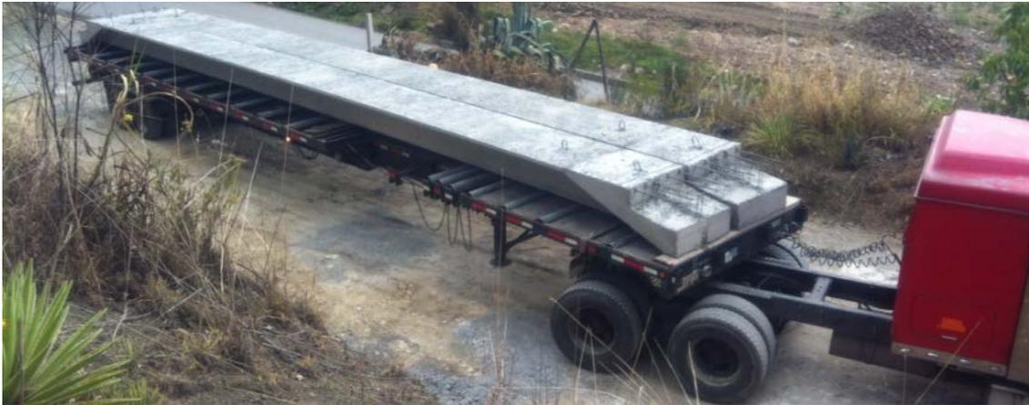
**Ilustración 3:** Fotografía de losas con cabezas rígidas pertenecientes al estacionamiento del “Parque de la Madre”
