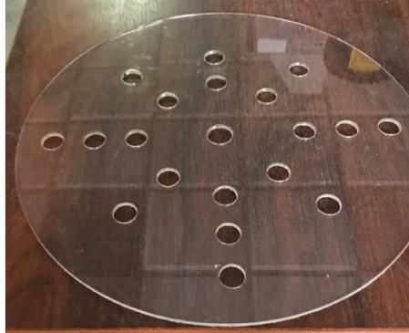
**Figura 8.** Placa de acrílico para separar las granulometrías. Fuente: Los Autores (2019)
