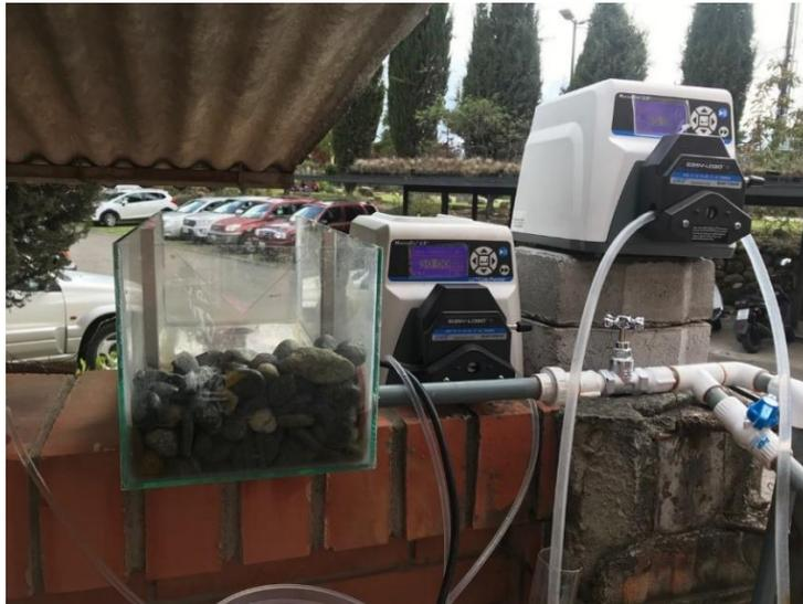
*Figura 7. Almacenamiento y dosificación de coagulante y polímero. Fuente: Los Autores (2019)*
