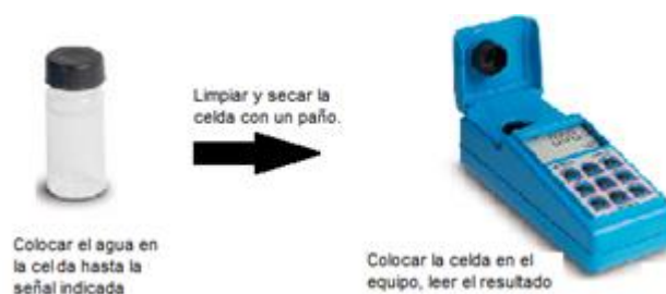
Figura 4. Determinación de turbiedad. (Fuente: Los autores)
