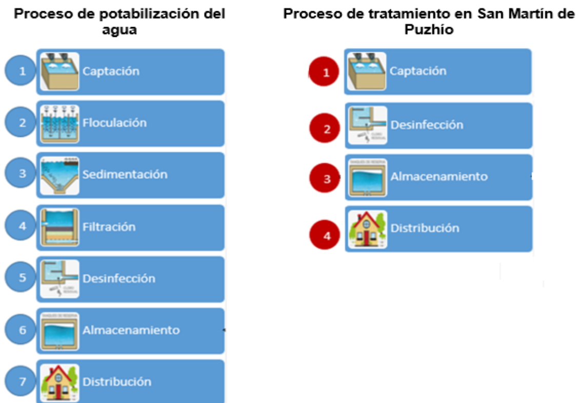
Figura 1. Sistema de potabilización del agua vs sistema de tratamiento del agua en la parroquia San Martín de Puzhio.
