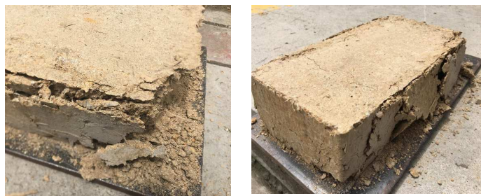
Figura 19 Bloques con fibras vegetales luego del ensayo de resistencia a la compresión. Fuente: Autor
