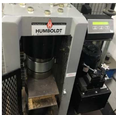
Figura 8 Aparato utilizado para el ensayo de resistencia a la compresión en el Laboratorio de Suelos de la Universidad del Azuay. Fuente: Autor
