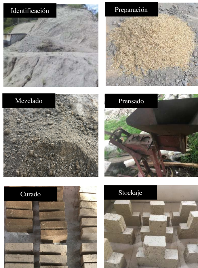
Figura 7 Etapas de Fabricación del BTC. Fuente: Rigassi (1995). Elaboración propia.
