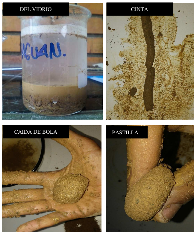
Figura 11 Imágenes de los ensayos de campo a la tierra Baguanchi. Fuente: Autor
