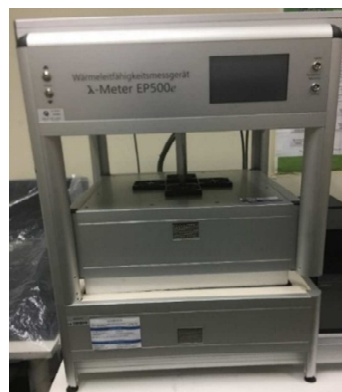
Figura 9 Aparato utilizado para la determinación de la conductividad térmica en el laboratorio LABET, de la Escuela Politécnica del Litoral. Fuente: Autor
