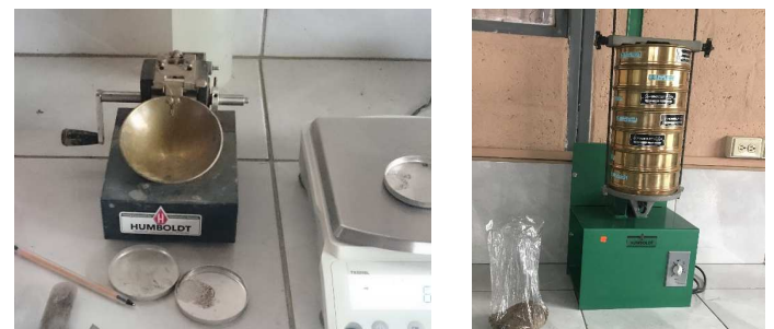
Figura 6 Equipos de ensayos de laboratorio de la Universidad del Azuay. (1) Método Casagrande. (2) Tamices para ensayo granulométrico. Fuente: Autor
