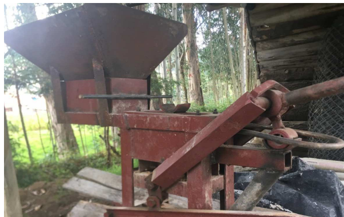
Figura 28 Máquina tipo CINVA-RAM fabricada para la producción manual de BTC. Fuente: Autor
