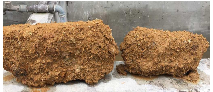
Figura 22 Bloques TR1 y TR2 previo al ensayo de resistencia a la compresión en húmedo. Fuente: Autor
