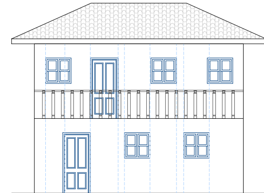
Figura 22: Discontinuidad de vanos en elevación.
