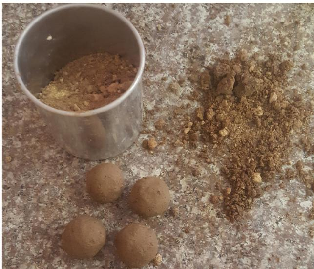
Imagen 3.14 Material prueba presencia de arcilla
