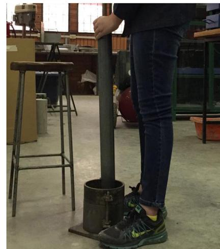
Imagen 3.31 Compactación ensayo de Próctor estándar
