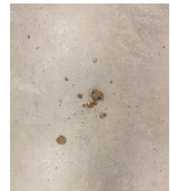
Imagen 3.13 Caída: prueba de contenido de humedad
