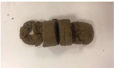
Imagen A1.21 Ensayo límite plástico
