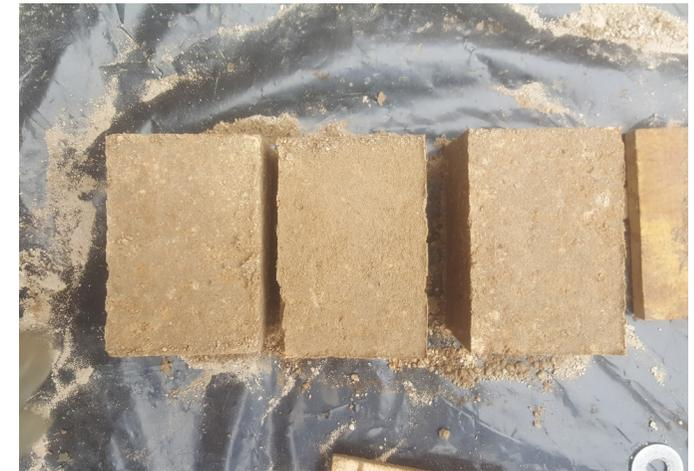
Imagen 4.12 Muestras después de desencofrado
