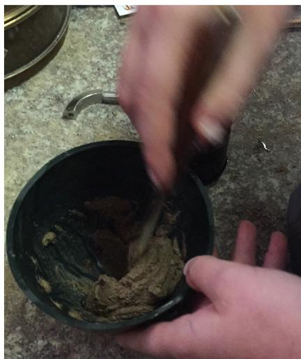
Imagen 3.25 Ensayo de límite líquido
