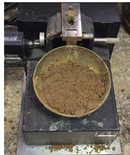
Imagen 3.26 Ensayo de límite líquido
