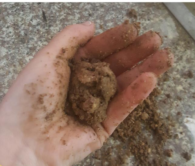
Imagen 3.15 Elaboración muestra prueba de presencia de arcilla
