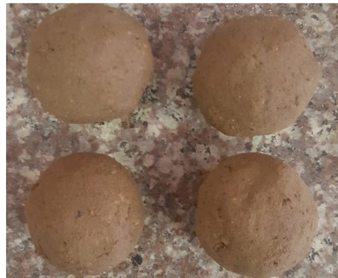
Imagen 3.16 Muestras prueba presencia de arcilla
