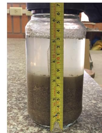
Imagen 3.9 Tierra a 24 horas para prueba de sedimentación
