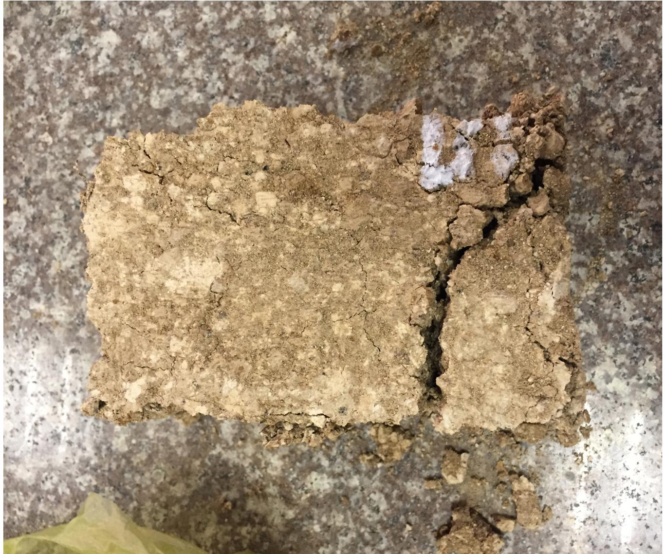
Imagen 4.21 Rotura de muestra al ensayar a compresión
