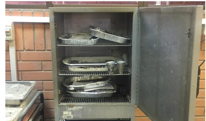
Imagen 3.22 Prueba de contenido de humedad
