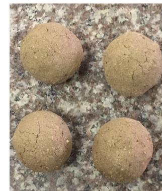
Imagen 3.12 Muestras prueba de contenido de humedad
