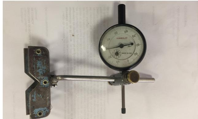
Imagen 4.17 Deformímetro
