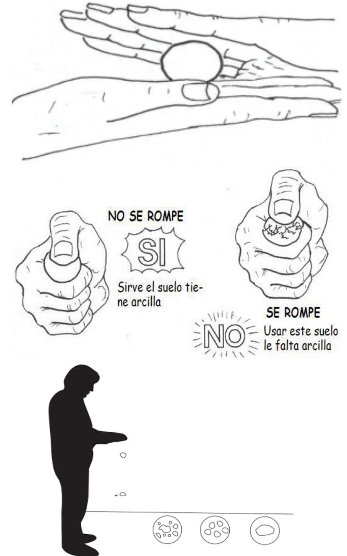
Imagen 3.1 Ejemplos de ensayos de campo para análisis de la tierra.
