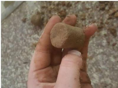
Imagen A1.20 Ensayo límite plástico
