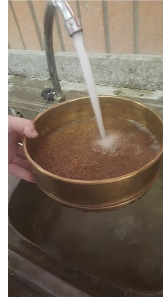
Imagen 3.18 Prueba de ensayo de lavado
