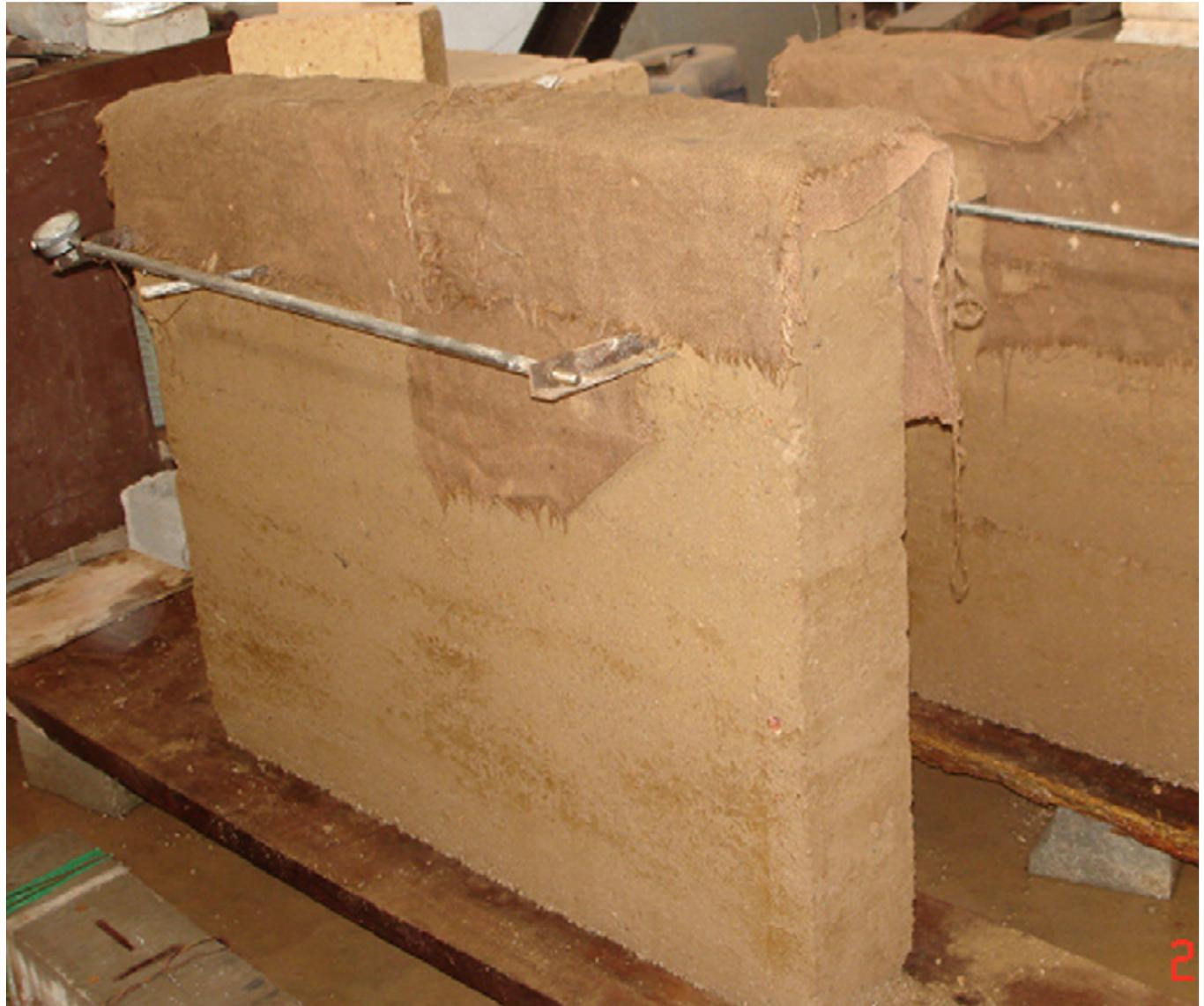
Imagen 2.20 Muro tapial estabilizado con cemento
