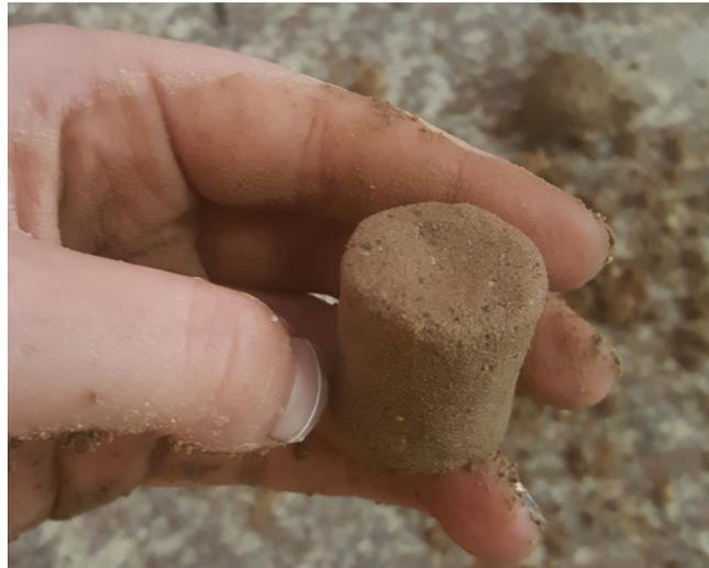
Imagen 3.28 Elaboración de muestra: ensayo de límite plástico
