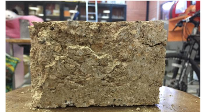
Imagen 4.19 Fisuras de la muestra después del ensayo a la compresión
