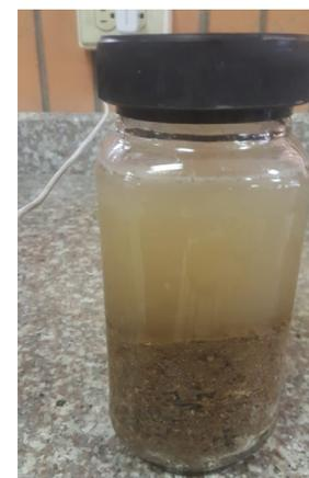
Imagen 3.8 Frasco prueba de sedimentación
