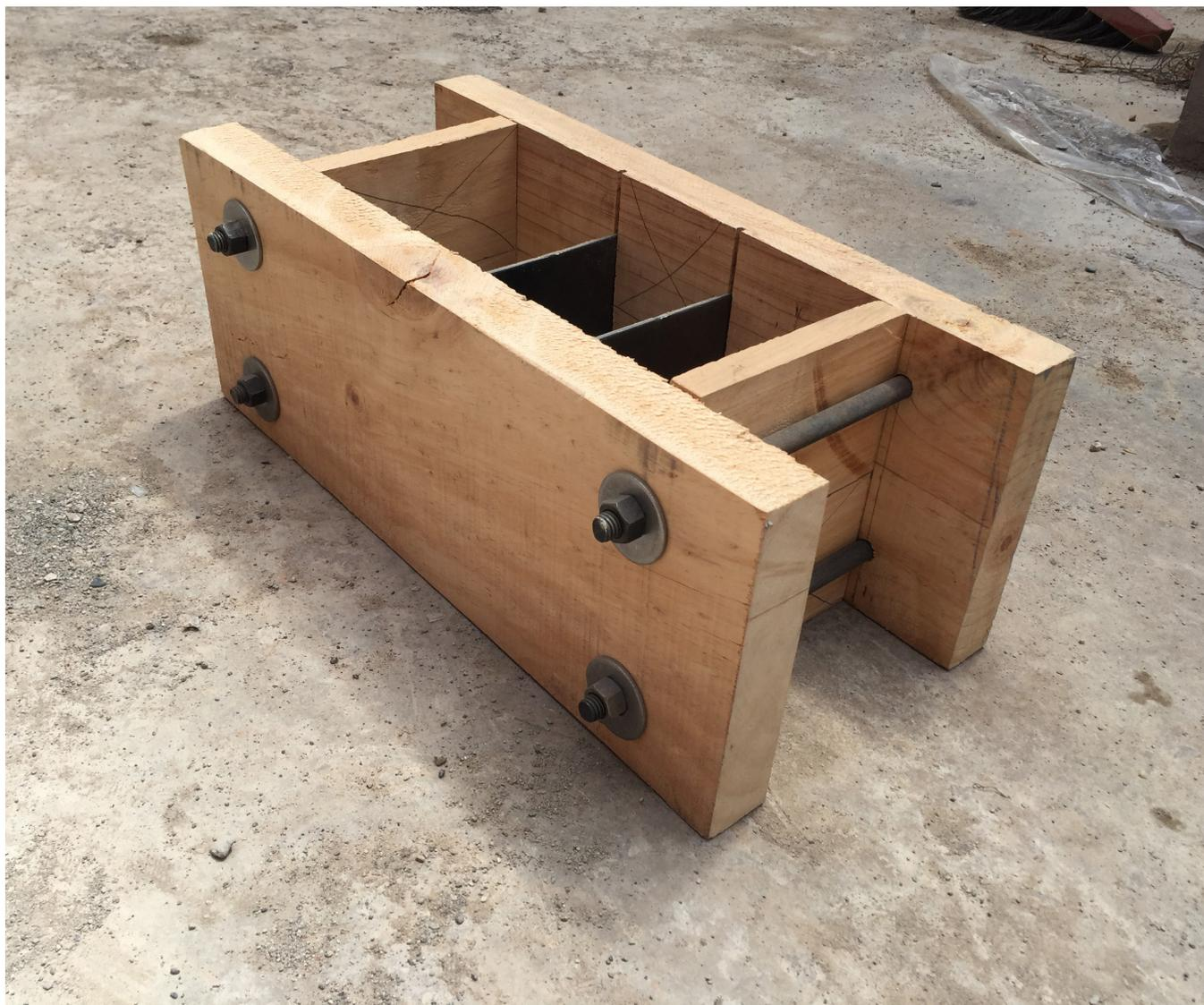
Imagen 4.6 Encofrado utilizado en elaboración de muestras
