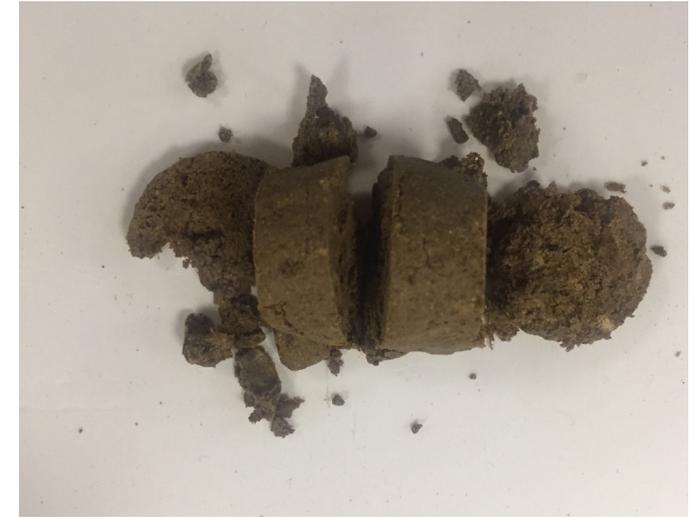
Imagen 3.29 División de muestra: ensayo de límite plástico
