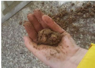
Imagen A1.19 Ensayo límite plástico
