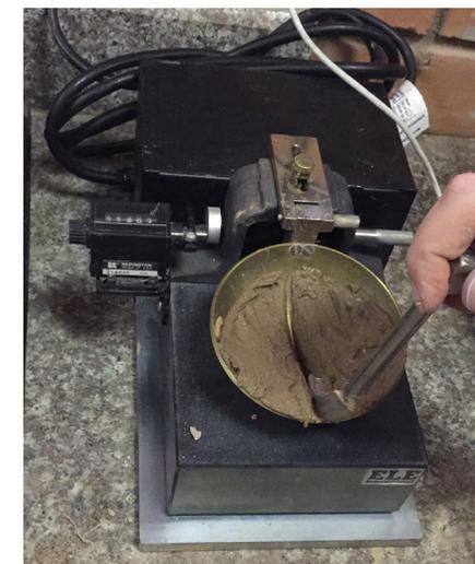
Imagen 3.27 Ensayo de límite líquido
