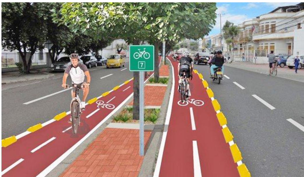
Ilustración 30. Diseño de una propuesta de trazado de una ciclo vía. Fuente: https://tdup01.wordpress.com/2010/11/23/propuesta/ .
