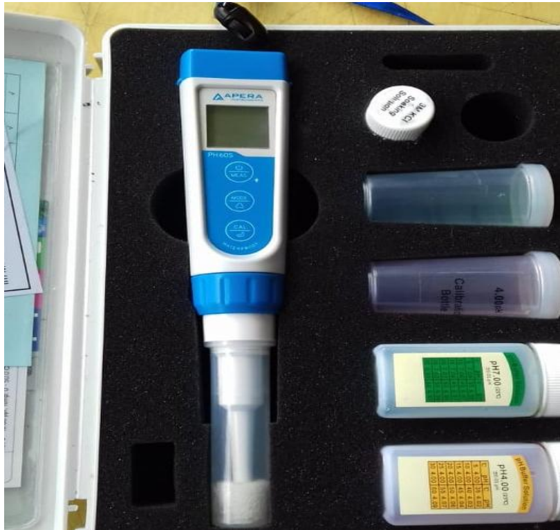
Anexo 3: Medidor de pH digital utilizado en el estudio, modelo APERA PH60S.
