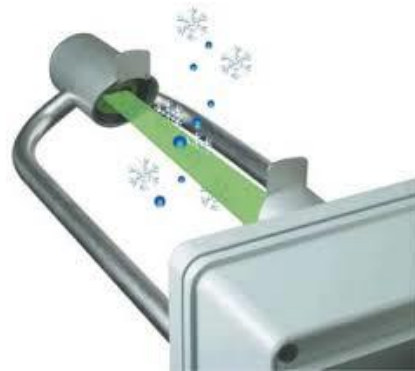
Ilustración 3: Principio de medición del Disdrómetro Laser Thies
