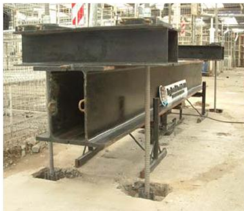
Figura 2.13 Marco de carga para ejecutar ensayos de carga a compresión.
