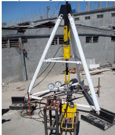
Figura 2.12 Marco de carga para la ejecución de ensayos de tracción.
