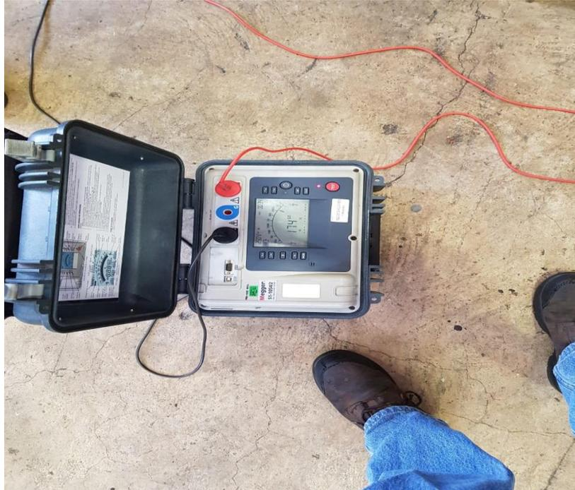
**Figura 2.11** Medición de la resistencia de aislamiento por personal especializado.
