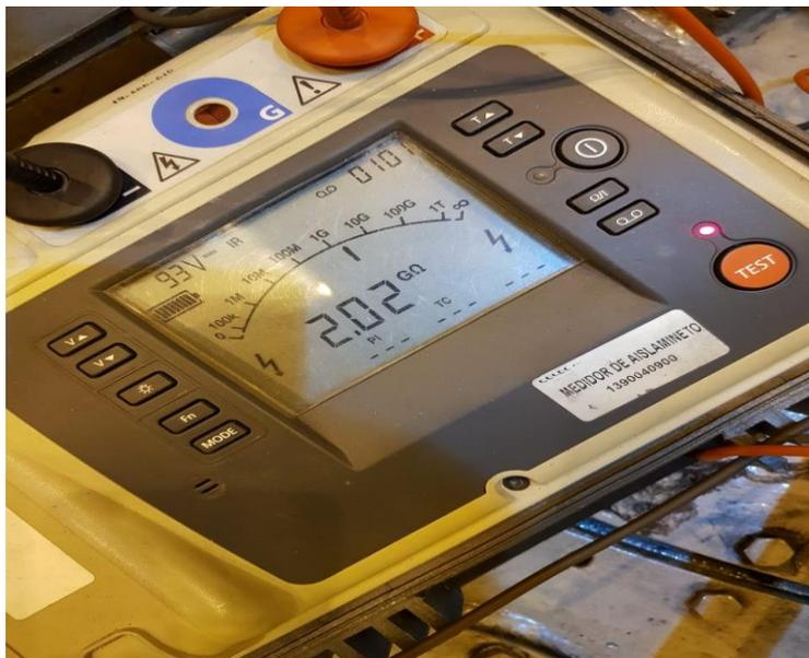
**Figura 2.10** Medidor de Resistencia de Aislamiento.
