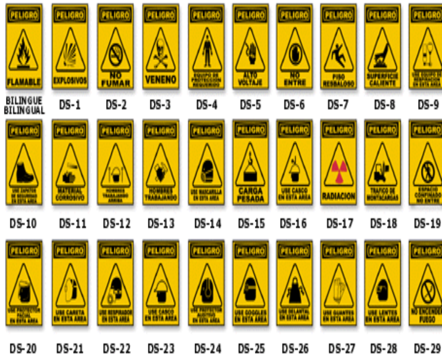
Figura 32 Señales de Peligro
