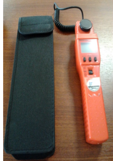
Figura 19 Luxómetro digital LM631 Fuente: Realizado por Christian Plaza
