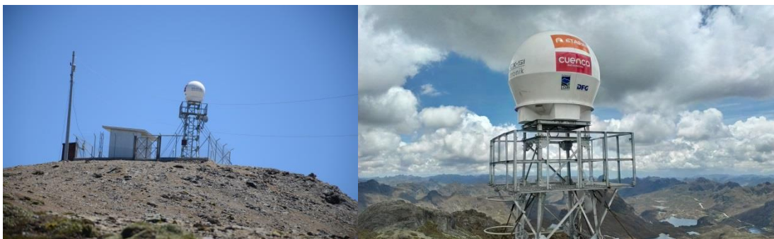
Figura. 2. Radar de banda-X: Radar CAXX RS120 RAINSCANNER sobre el cerro Paraguillas (4450 m s.n.m.)
