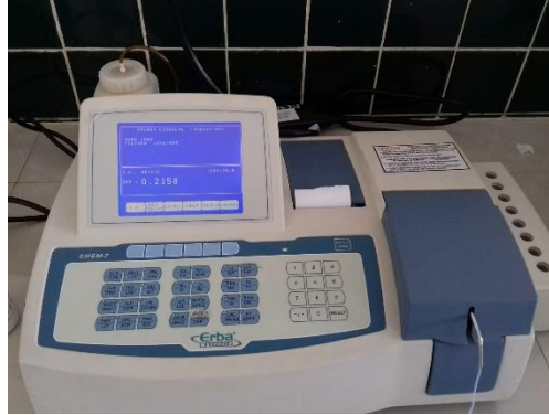
Foto1. Espectrofotómetro marca ERBA utilizado en la práctica.
