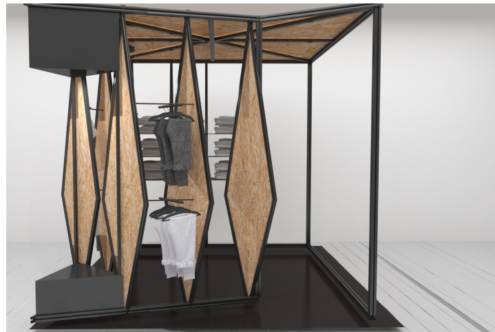
Paso 10: Se observa como queda el espacio de venta temporal dentro de la feria, con la colocación de los productos mediante tubos de aluminio redondos.
