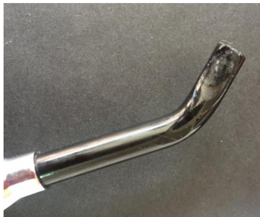
Ilustración 3: Fractura de la Fibra Óptica. Fuente: Rodas, Villalta
