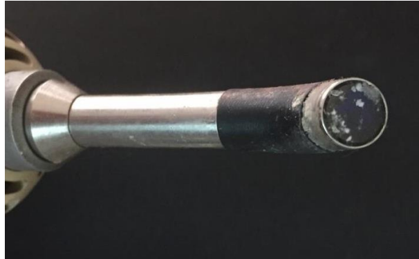
Ilustración 4: Residuos de Biomateriales Dentales sobre la Fibra Óptica. Fuente: Rodas, Villalta
