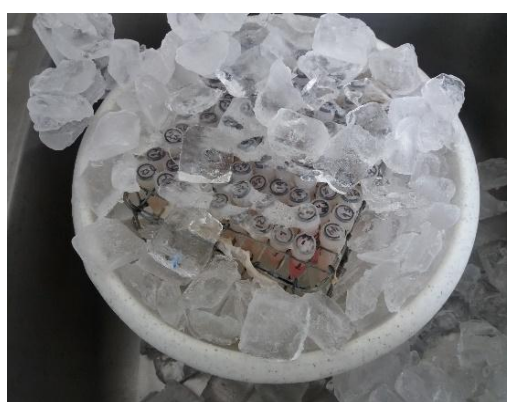
Foto 7. Muestras en Baño María 95 °C y enfriamiento en baño de hielo
