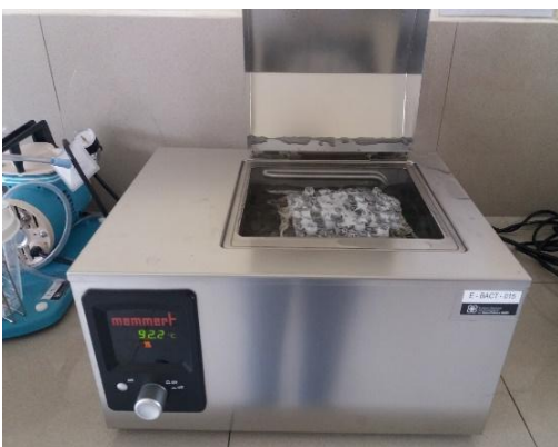
Foto 7. Muestras en Baño María 95 °C y enfriamiento en baño de hielo
