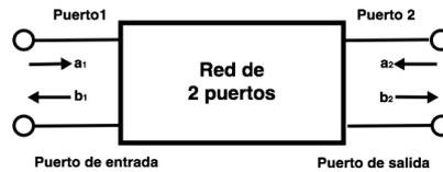
Figura 2.3: Ondas incidente y reflejada en una red de dos puertos.
