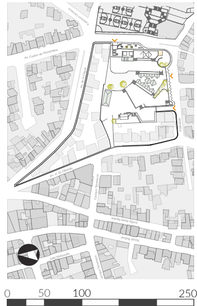
Gráfico 40: Planta de emplazamiento actual del mercado de San Francisco, se evidencian los accesos al predio. disponibles.
