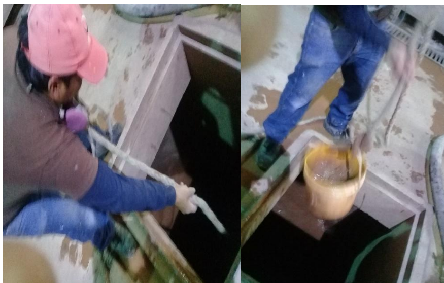
Figura 8: Muestreo en la cisterna de almacenamiento de efluentes Fuente: El autor
