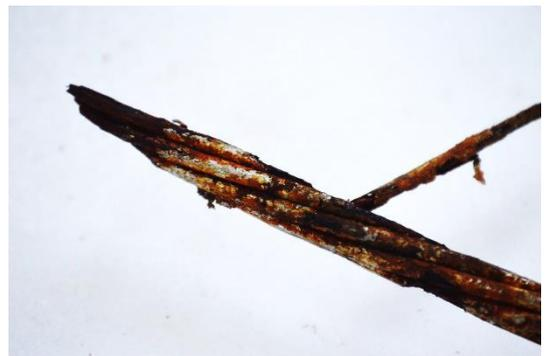
**Figura 4.9.** Conductor del SPAT oxidado. (fuente autores)
