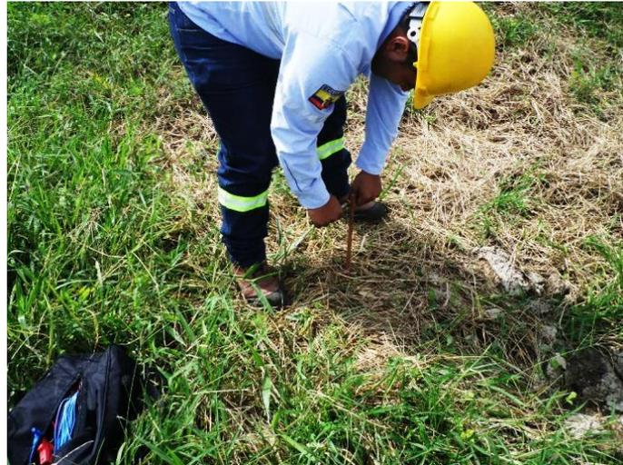
**Figura 4.2.** Colocación de los electrodos en el terreno (fuente autores)
