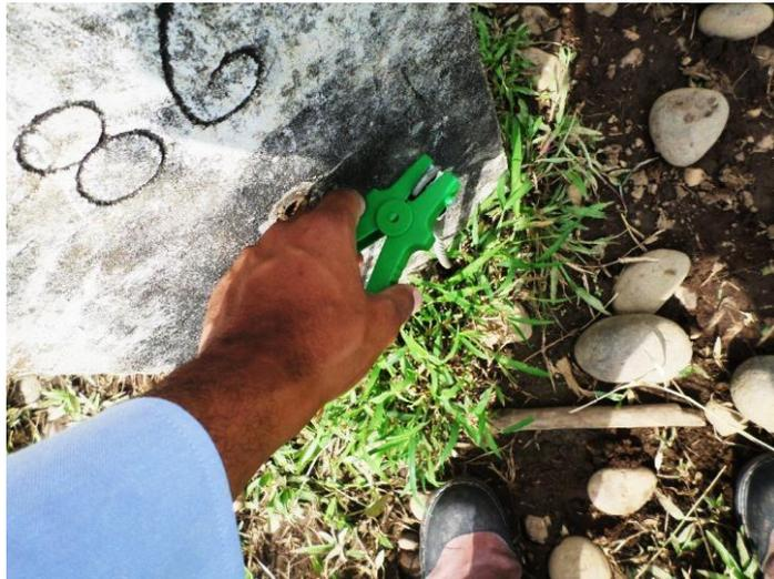
**Figura 4.5.** Conexión de la pinza al conductor inferior del poste. (fuente autores)
