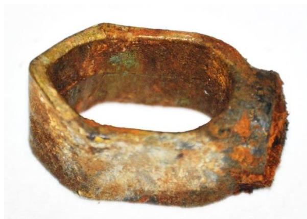
**Figura 4.10.** Conector copperweld oxidado. (fuente autores)
