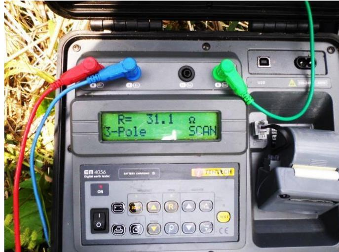
**Figura 4.6.** Medición de la resistencia de la puesta a tierra. (fuente autores)
