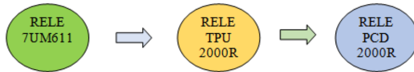
Figura 4.46. Flujograma para falla externa trifásica. (Fuente Autores).
