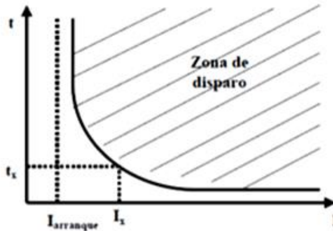
Figura 4.25. Curva de operación de un relé de tiempo inverso. [17]
