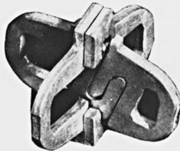
En el ensamblaje se anidan tres partes, la cuarta es conducida a su posición con un martillo. Los diagramas anteriores muestran cómo por medio de un borde asimétrico es posible efectuar cualquier combinación deseada, con lo cual todos los elementos son intercambiables y las superficies quedan al ras después del montaje.
