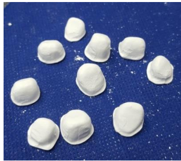
Foto 37: Estructuras de dióxido de zirconio listas para la sinterización
