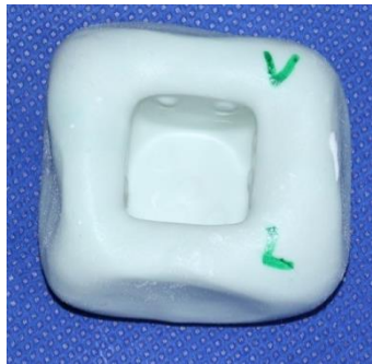
Foto 4: Molde cuadrado en silicona de condensación Zetaplus Putty 900ml Silicona-C
