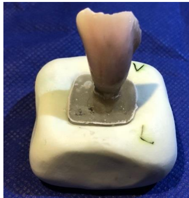
Foto 5: Raíz embebida con acrílico auto polimerizable transparente extendido hasta 2mm por debajo de la unión cemento esmalte
