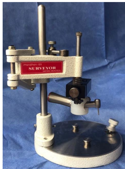
Foto 8: Surveyor (Modelo Marathon 103, Saeyang Microtech, Serie No. 1412167, Korea
