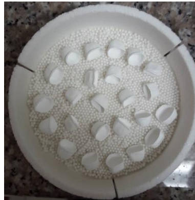
Foto 38: Estructuras de dióxido de zirconio sobre perlas de zirconio
