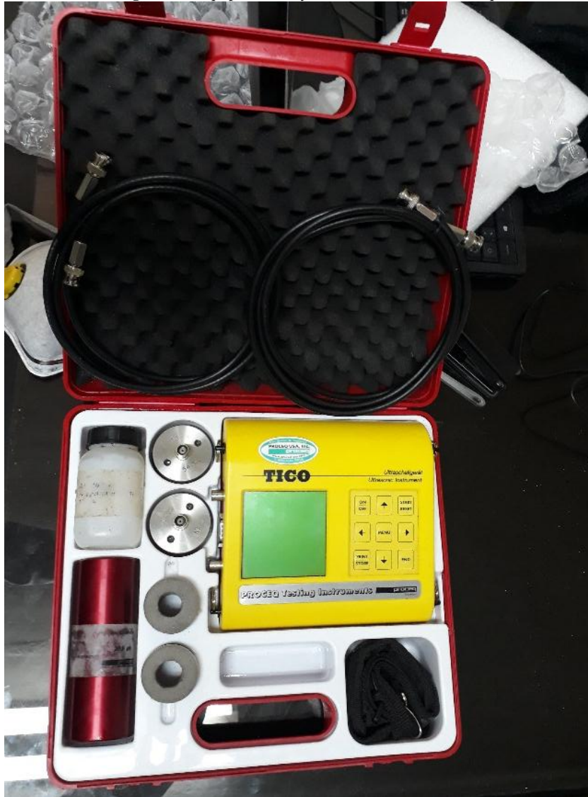
Fotografía 5. Equipo de ensayo ultrasónico marca Proceq.
