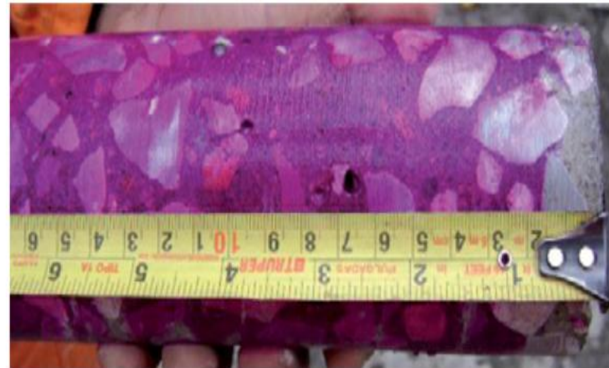
Fotografía 6. Profundidad de carbonatación.
