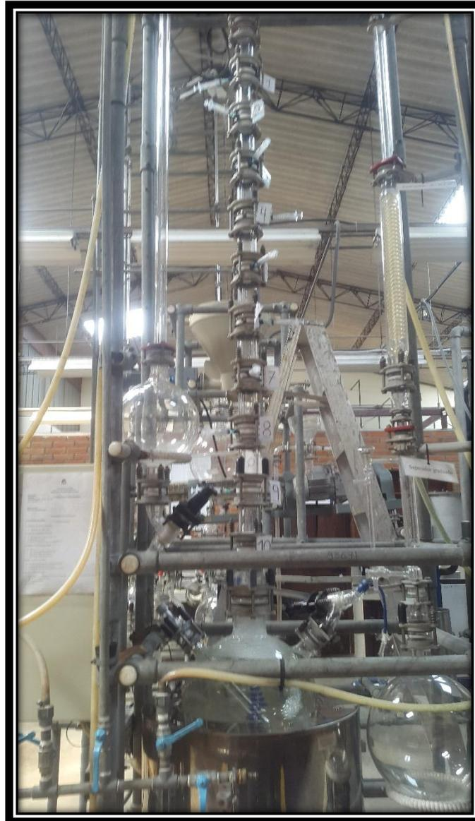
*Foto 6. Columna de rectificación con las jeringas para la toma de muestras en cada plato.*
