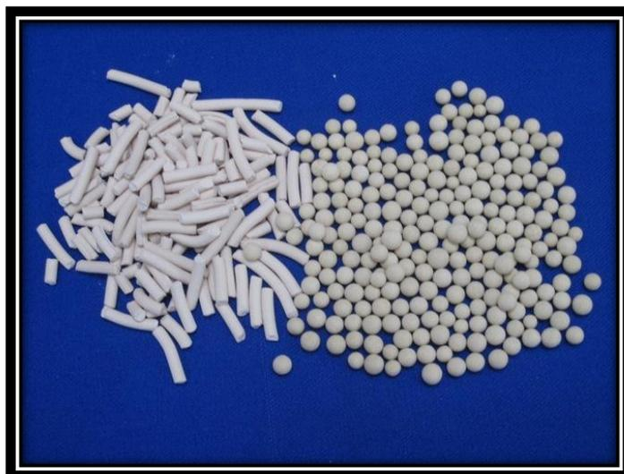
Foto 3. Tamiz molecular de forma cilíndrica y esférica.
