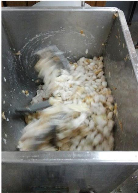
**Figura 134.** Fotografía del ablandamiento del mucílago de cacao CCN – 51. Tomada en el Laboratorio de Tecnología de Conservas Vegetales.
