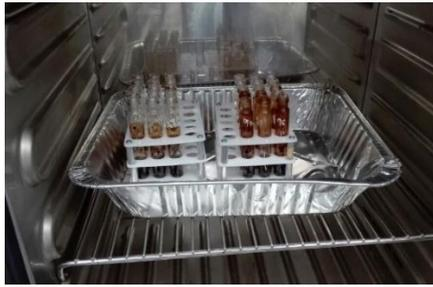
**Figura 185.** Fotografía del secado de muestra. Tomada en el Laboratorio de Energía e Ingeniería de la Reacción.
