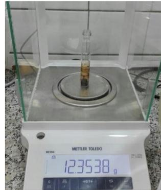
**Figura 188.** Fotografía del pesaje del tubo más muestra seca. Tomada en el Laboratorio de Energía e Ingeniería de la Reacción.
