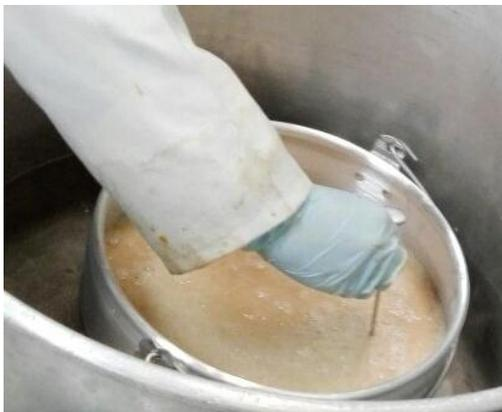
**Figura 140.** Fotografía de la pasteurización del mucílago de cacao CCN – 51. Tomada en el Laboratorio de Tecnología de Conservas Vegetales.
