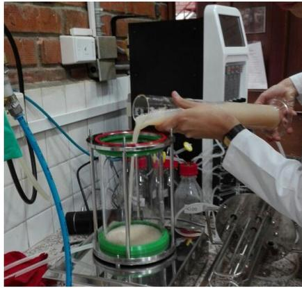
**Figura 158.** Fotografía del llenado del Biorreactor con mucílago de cacao CCN – 51. Tomada en el Laboratorio de Energía e Ingeniería de la Reacción.
