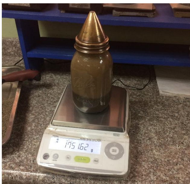
Figure 5-14: Picnómetro para determinar la densidad del árido fino.
