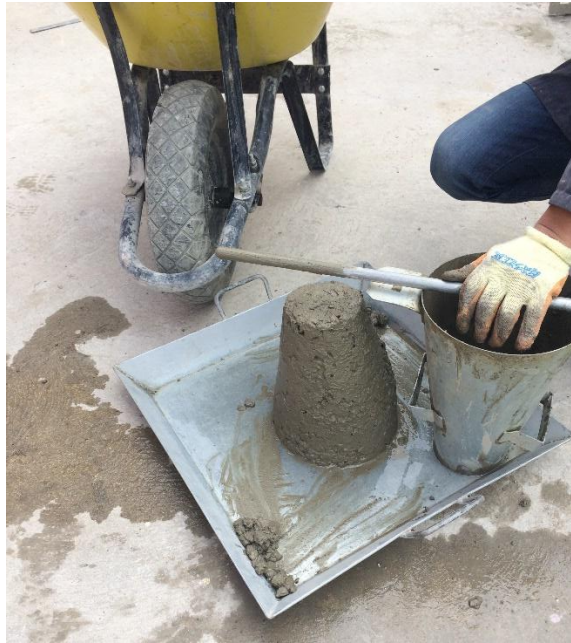
Figura 5-21: Evaluación del asentamiento en el cono de Abrams
