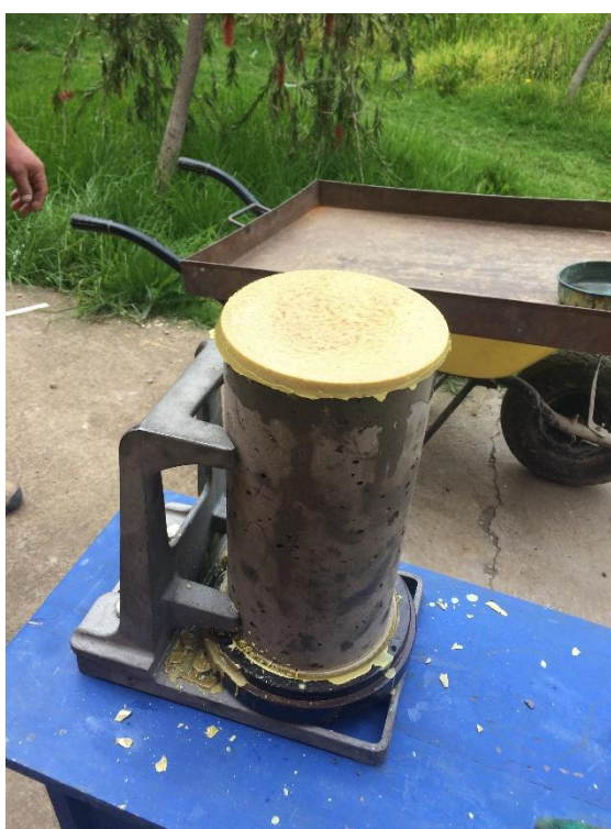
Figura 5-24: Refrentado con mortero de azufre. (Autor 2017)
