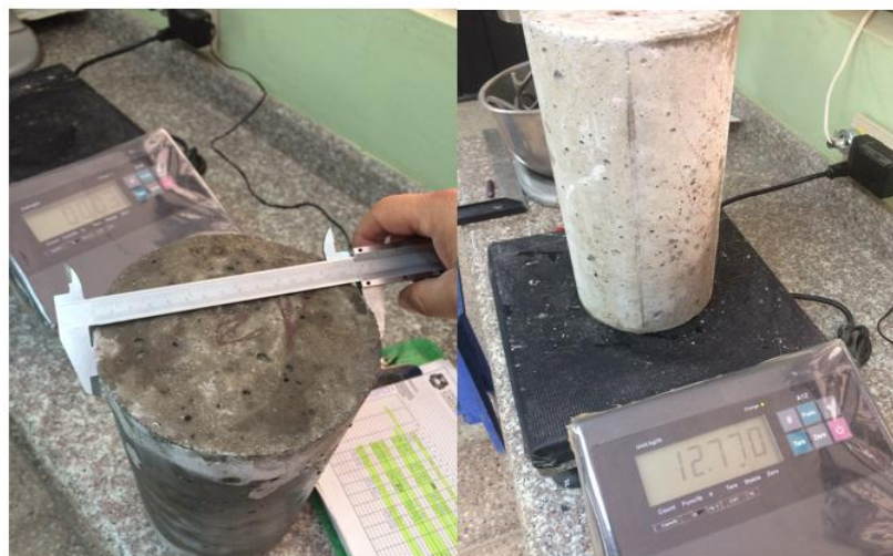
Figura 5-25: Toma de dimensiones y de pesos de las probetas cilíndricas antes del ensayo (Autor 2017)
