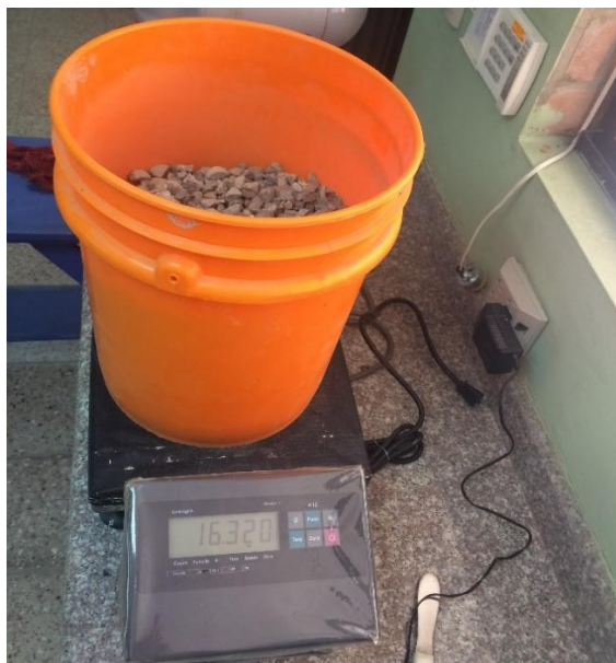
Figura 5-20: Pesaje de los áridos
