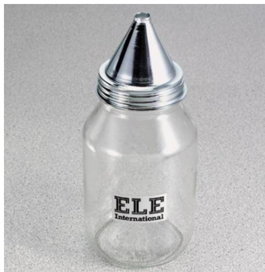
Figura 2-10: Picnómetro para densidad de arena (ELE International)
