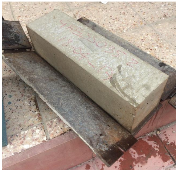
Figura 5-22: Desmoldado de las muestras
