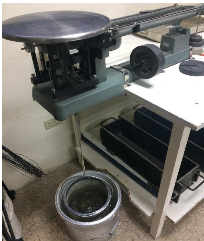
Figura 5-17: Determinación del peso sumergido en agua del árido grueso en condiciones SSS
