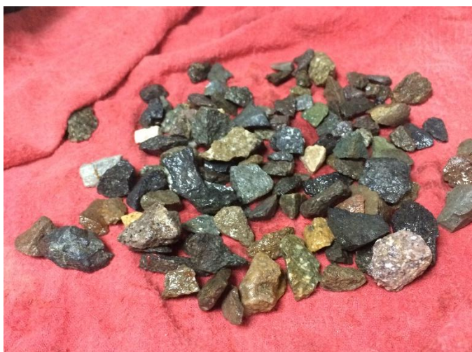
Figura 5-15: Eliminación de la humedad superficial del árido grueso mediante secado con telas absorbentes
