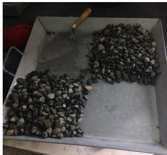
Figura 5-8: Cuarteo del árido grueso
