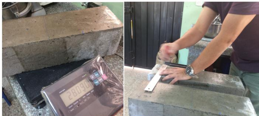
Figura 5-26: Medición, pesaje y marcado de las vigas antes del ensayo (Autor 2017)
