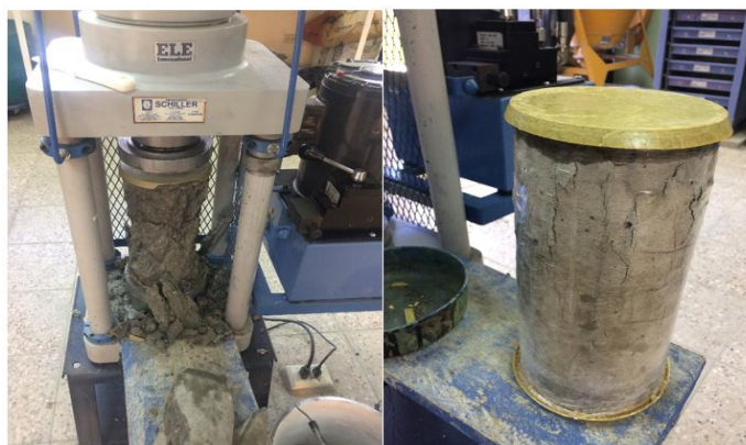
Figura 5-27: Dos ensayos con similares tipos de falla. La imagen de la izquierda muestra una muestra de alta resistencia y falla abrupta.
