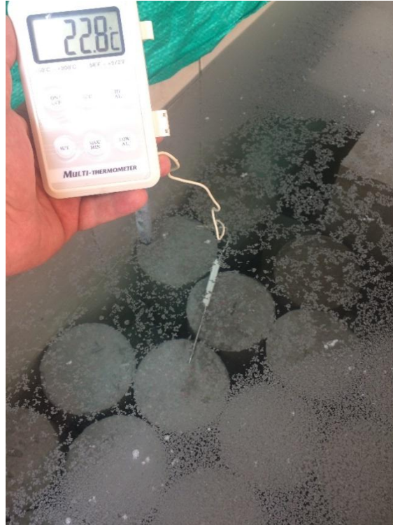
Figura 5-23: Curado por inmersión y control de la temperatura de curado (Autor 2017)
