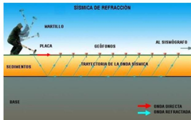
Figura 2.11: Prospección sísmica por refracción, Referencia [6]
