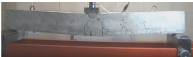
Figura 11. Falla de viga a flexión.
