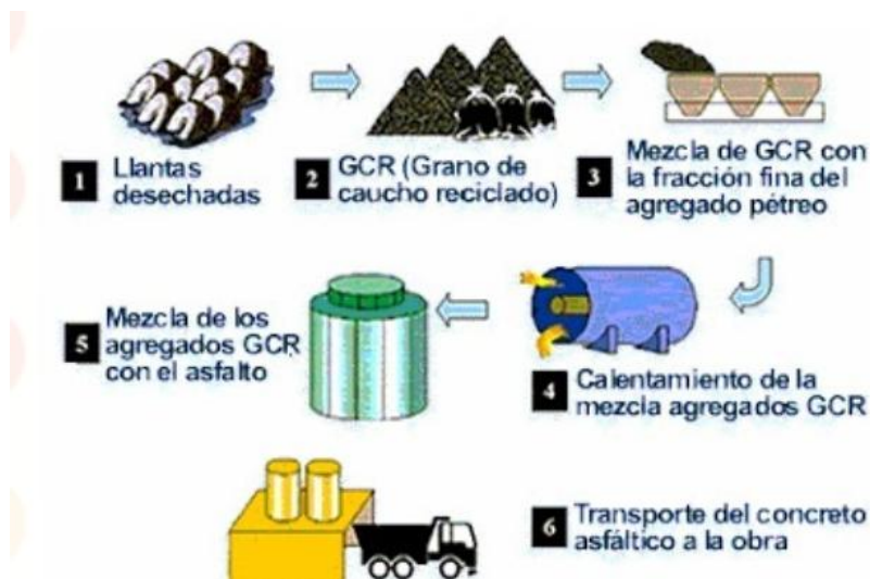
Figura 93. Proceso de mezclado en seco. Asfalto-neumáticos Fuente: "Mezclas de asfalto modificadas con llantas" (s. f.)
