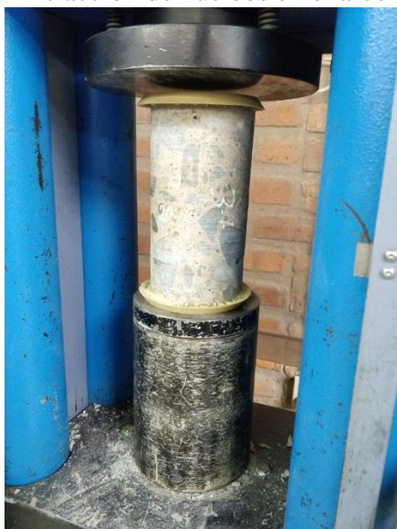
Ensayo de compresión simple de núcleo
