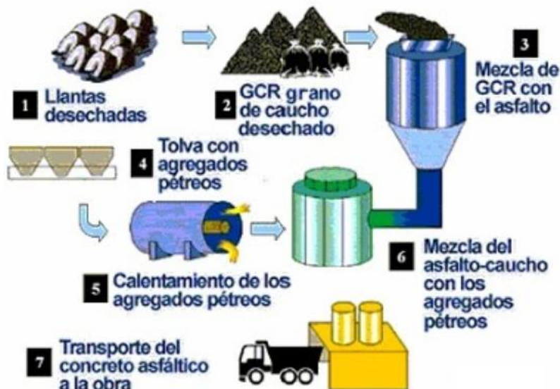
Figura 92. Proceso de mezclado en húmedo. Asfalto-neumáticos Fuente: "Mezclas de asfalto modificadas con llantas" (s. f.)
