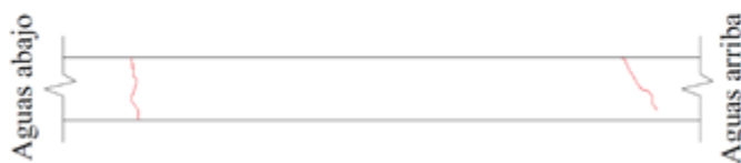
Figura 60. Ubicación de fisuras en Viga 4.3
