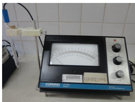
FIGURA 5. Potenciómetro Corning Glass Work tomado en el Laboratorio de Análisis Biológico de la Universidad de Cuenca. (Realizado por las autoras)
