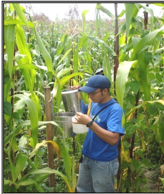
Foto 4. Instalación Pluviómetro tipo Hellman 2008 Pesántez P, Seminario M.
