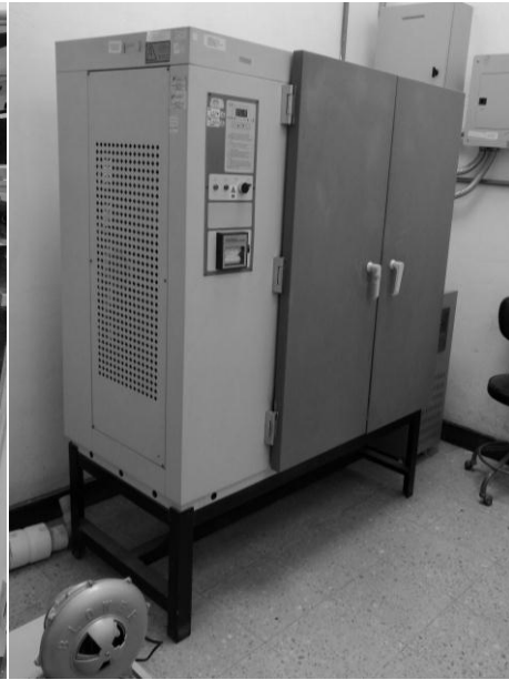
PERALTA JORGE, 2017, MUFLA Horno para secado artificial. [Imagen 40]
