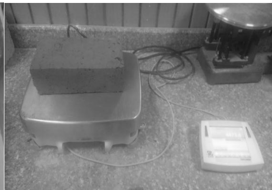
PERALTA JORGE, 2017, Pesaje de ladrillos después de sumersión. [Imagen 14]
