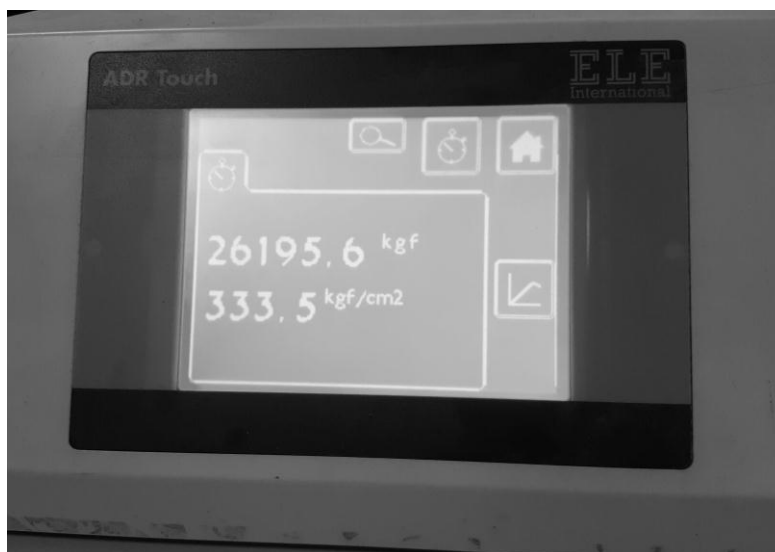
PERALTA JORGE, 2017, Valor máximo de la Resistencia Mecánica a la Compresión obtenido en la Mezcla 2. [Imagen 52]
