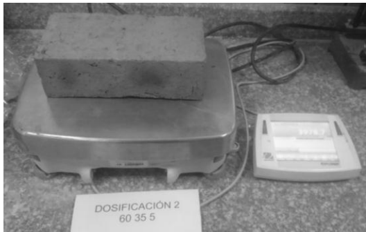
PERALTA JORGE, 2017, Toma de peso de la muestra en seco. [Imagen 46]
