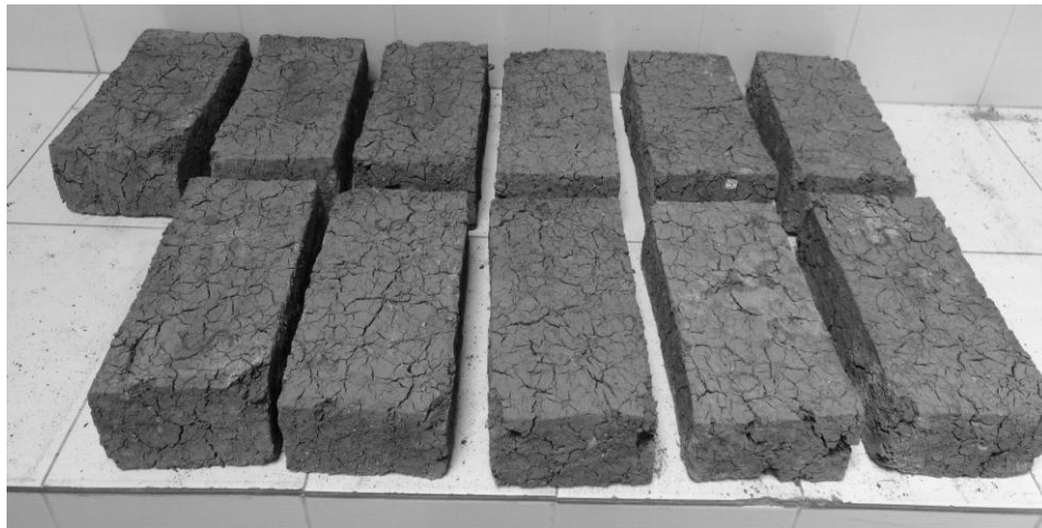
PERALTA JORGE, 2017, Dosificación 5 posterior a su secado artificial. [Imagen 41]
