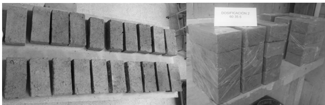
PERALTA JORGE, 2017, Posterior a cocción de ladrillo. [Imagen 45]
