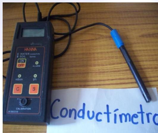
Foto N° 47. Conductímetro
