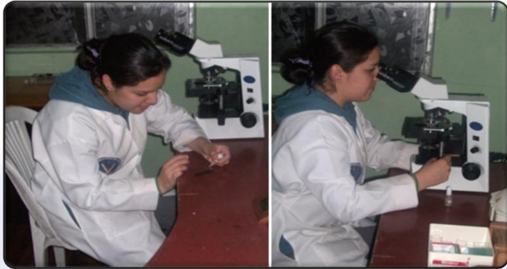
Figura 9. Una vez que se hayan secado las muestras, se coloca una gota de aceite de inmersión y se observa en el microscopio.
