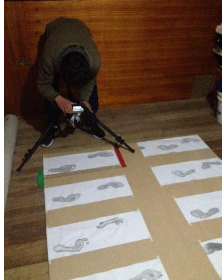
Imagen 39: Colocación del trípode y cámara a 90°. Fuente: Propia de los autores.
