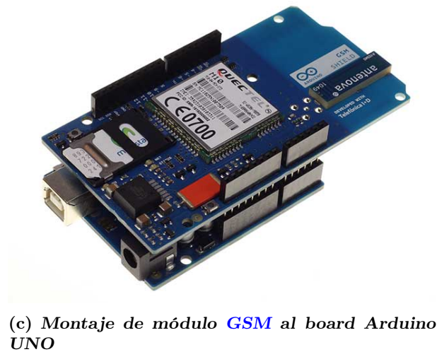
Figura 5.5: Dispositivo GSM usando hardware libre ARDUINO.
