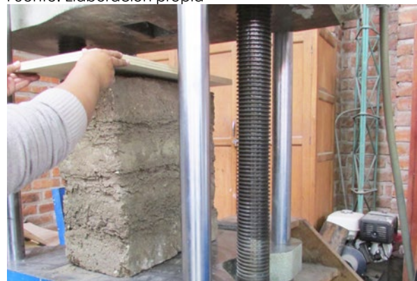
Figura 61. Ensayo del murete Fuente: Elaboración propia
