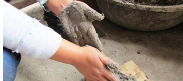
Figura 24. Prueba de lavado de manos Fuente: Elaboración propia
