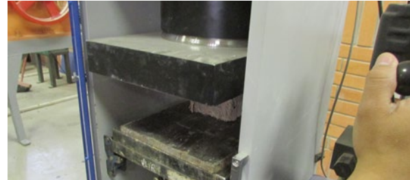
Figura 45. Ensayo a compresión
