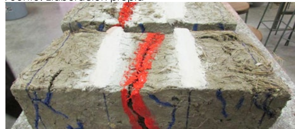
Figura 56. Señalado de la fractura en la muestra Fuente: Elaboración propia
