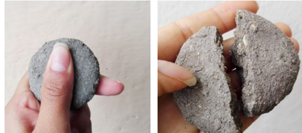
Figura 27. Prueba de resistencia seca Fuente: Elaboración propia
