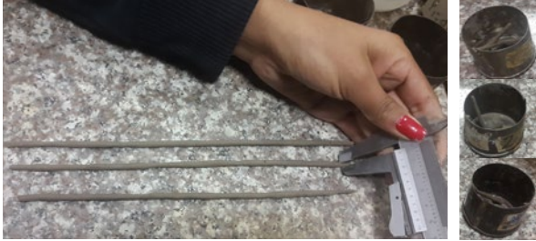
Figura 32. Ensayo de Límite plástico Fuente: Elaboración propia
