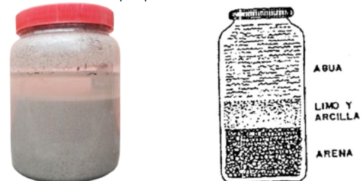
Figura 26. Prueba de sedimentación Fuente: Elaboración propia
