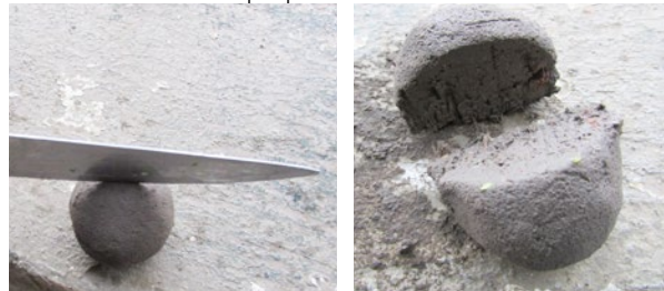
Figura 25. Prueba de corte con cuchillo Fuente: Elaboración propia
