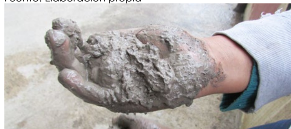
Figura 29. Prueba del exudación Fuente: Elaboración propia
