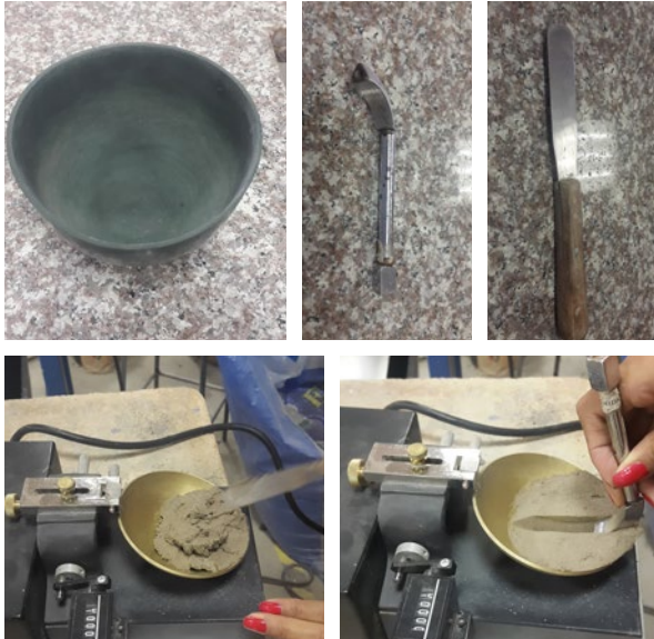
Figura 31. Ensayo de límite líquido. Fuente: Elaboración propia
