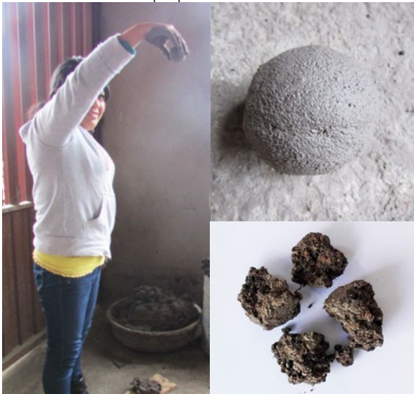
Figura 23. Prueba de impacto Fuente: Elaboración propia
