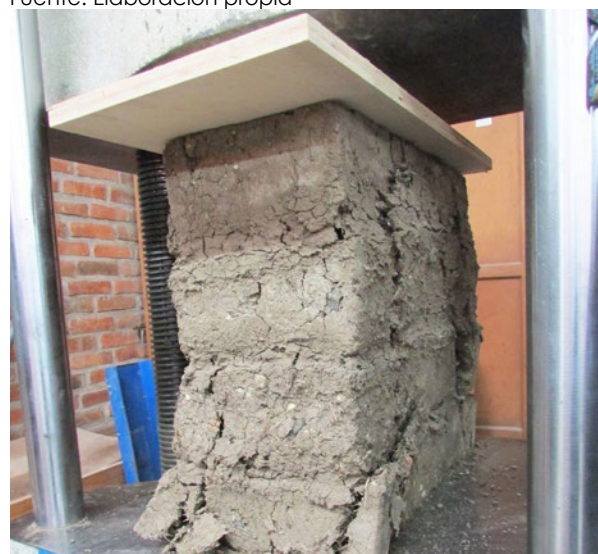
Figura 62. Fractura producida después del ensayo Fuente: Elaboración propia
