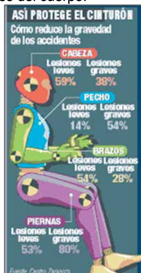
Fig. 4. Porcentajes aproximados de las lesiones evitadas con el uso del cinturón de seguridad de tres puntos. Imagen tomada de la página: http://www.dgt.es/revista/num150/pages/seguridadpasiva.html
