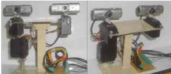
Figura 2.1. Vista del sistema para medición de distancias.
