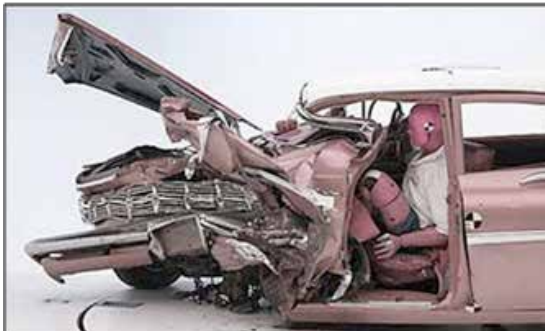
Fig. 10 y 11. Después de la colisión, a la izquierda el vehículo antiguo y a la derecha el vehículo nuevo. Imagen tomada de la web: http://javierurautocar.blogspot.com/2011_05_01_archive.html
