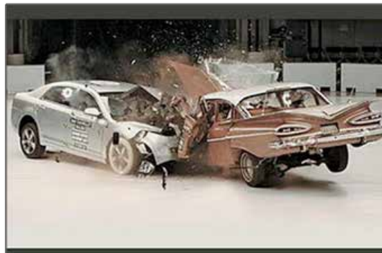
Fig. 8 y 9. En la prueba de impacto frontal se colisionan dos vehículos. Uno antiguo y uno actual. En las imágenes se ilustra la prueba antes y durante la colisión. Imagen tomada de la web: http://javierurautocar.blogspot.com/2011_05_01_archive.html
