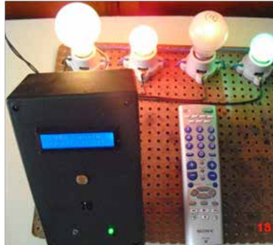
Fig. 8 Equipo funcionando en modo dimmer
