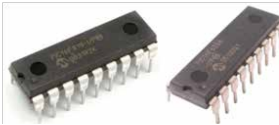
Fig. 2 PIC 16f628A y 16f819 utilizados
