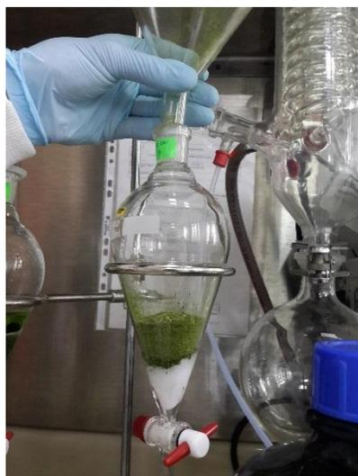
**Fig. 24:** Ensamblaje de percolador
