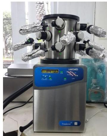
**Fig. 31:** Ensamblaje de Liofilizador Labconco Free zone 2.5
