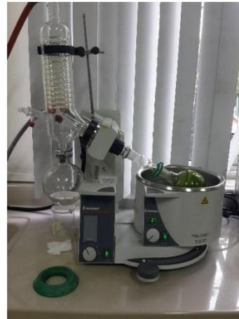
**Fig. 27:** Concentración del extracto fluido en Rotavapor Heidolph Laborota 4000 Efficient HB digital
