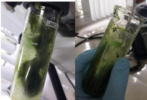
**Fig. 32:** Extracto metanólico seco obtenido por liofilización
