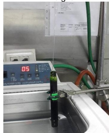
**Fig. 29:** Eliminación del solvente mediante nitrógeno en el baño ultrasónico
